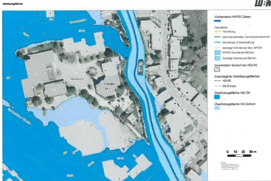
Abbildung 1: Auszug aus den Hochwassergefahrenkarten mit den Überflutungsflächen von HQ 100 und HQ extrem aus den amtlich festgesetzten Hochwassergefahrenkarten.
