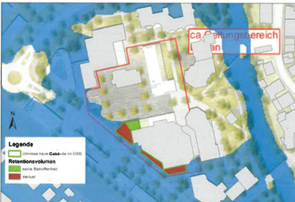
Abbildung 3: Detail mit den Bereichen, die neu bebaut werden sollen u. in denen ein Verlust des Retentionsvolumens entsteht
